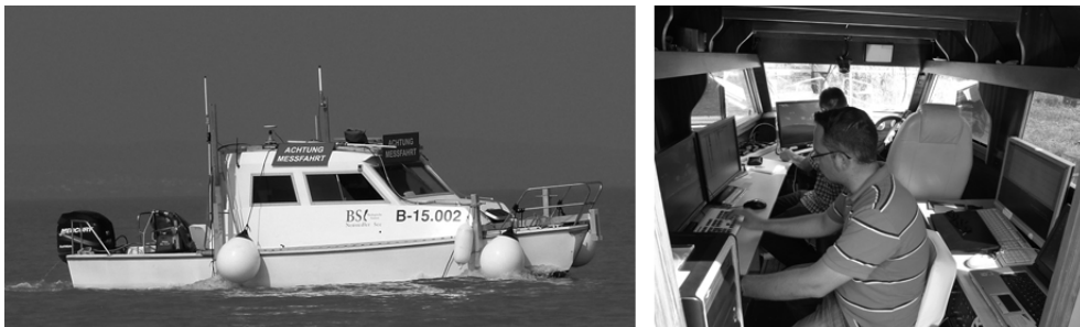
Abb.1: Außen- und Innenansicht des zum hydrographischen Vermessungsboot umgebauten Kajütbootes der Biologischen Station Neusiedler See
