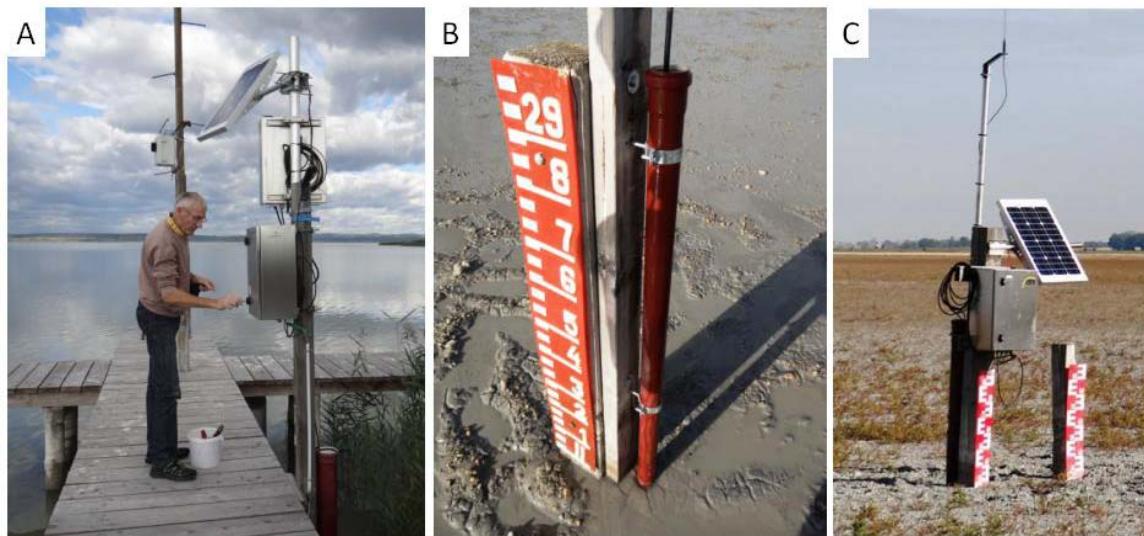
Abb. 1: Die beiden Sensortypen der online Meß-Sonden. A: Hydrolab-Multiparametersonde am Steg vom Neusiedlersee, B: PLS-C Sonde in der Lacke Unterstinker, C: kombiniertes Messen der Hydrolab-Multiparametersonde und PLS-C Sonde in der Langen Lacke bei Wasserführung.
