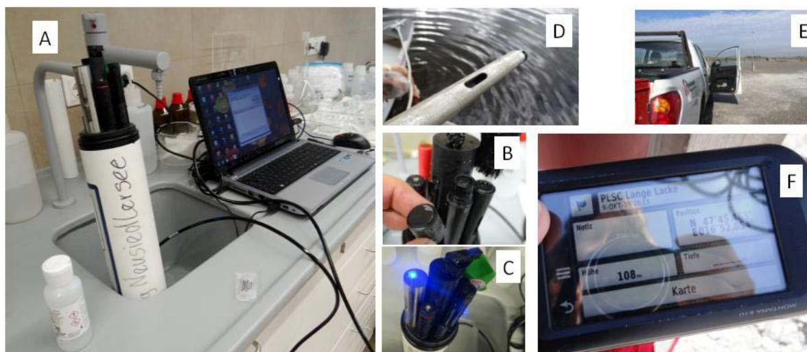
Abb. 2: Die Wartung von den Hydrolab-Multiparametersonde und PLS-C Sonden wurden sowohl im Labor als auch im Gelände durchgeführt. A-C: Hydrolabsonde, C: blaues Licht zur Anregung des Chlorophylls. D: PLS-C Sonde, E-Geländebegehung, F: Erfassung der GPS-Koordinaten.
